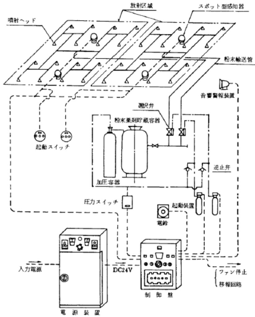
図8-2 粉末消火設備粉末容器附属機器図例
